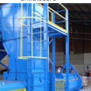
Platformă de întreținere
